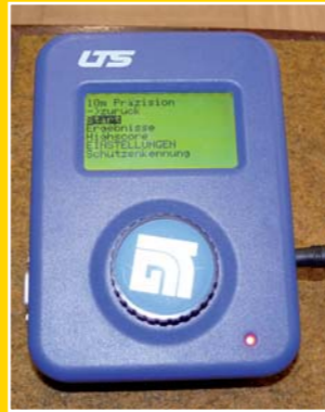
Controller: Hier werden die einzelnen Disziplinen ausgewählt und z. B. die Biathlon-Schießergebnisse angezeigt.
